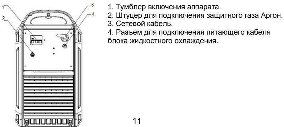
Рисунок 2. Задняя панель
