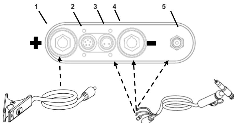
Рисунок 24. Подключение сварочных принадлежностей при TIG сварке
