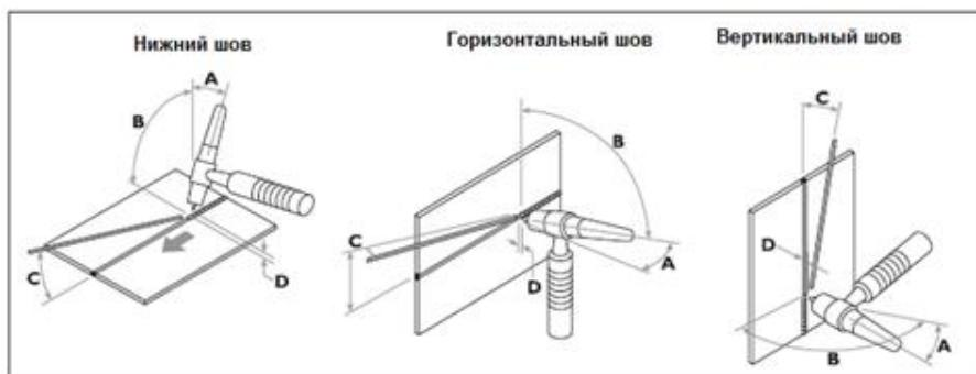
**Рисунок 25. Базовые движения при работе с аргонодуговой горелкой**
