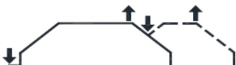
Рисунок 4. 2x тактный режим работы горелки
