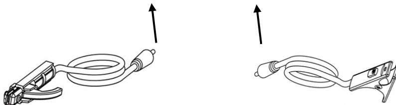
**Рисунок 13. Подключение сварочных принадлежностей при MMA сварке**
