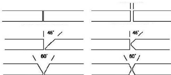
Рисунок 10. Стыковые соединения
