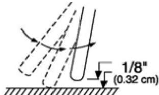
Рисунок 14. Зажигание дуги
