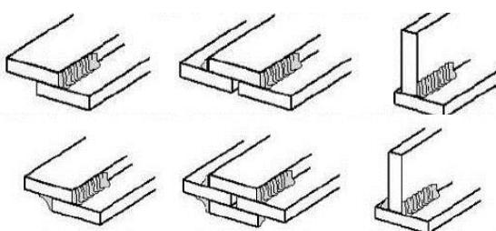
Рисунок 11. Угловые соединения
