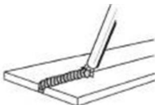
Рисунок 17. Нижнее положение при сварке
