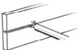
Рисунок 18. Горизонтальное положение при сварке
