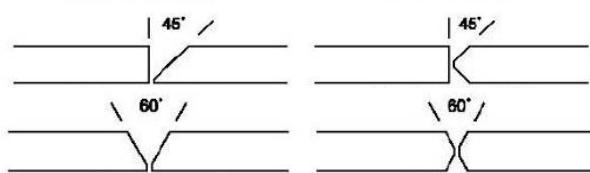
Рисунок 10. Стыковые соединения
