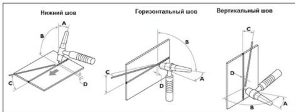
**Рисунок 24. Базовые движения при работе с аргонодуговой горелкой**
