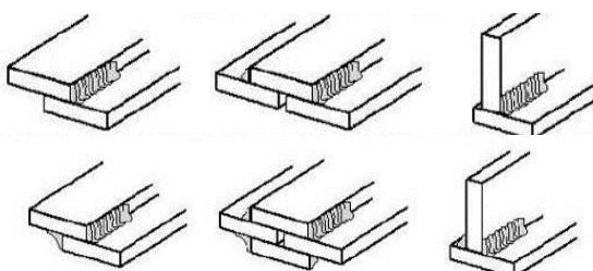
Рисунок 11. Угловые соединения
