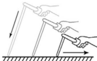
**Рисунок 14. положение электрода при сварке**
