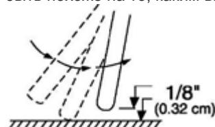
Рисунок 13. Зажигание дуги
