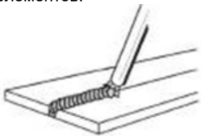
Рисунок 11. Нижнее положение при сварке
