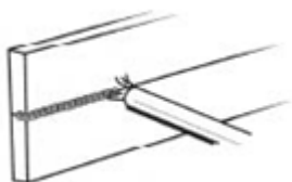
Рисунок 12. Горизонтальное положение при сварке
